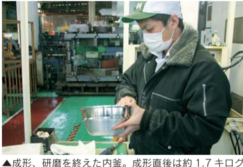
▲成形、研磨を終えた内釜。成形直後は約1.7キログラムの重さがあるが、研磨で重さはその半分に。製品はこの後、家電メーカーでコーティング加工などが施される
