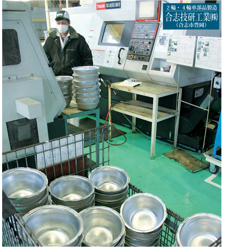
▶成形後の内釜。これから写真後方の研磨機にかけられる。同社による完成品に近い形にする「ニアネットシェイプ」と呼ぶ成形法が特徴だという。現在ラインでは7人が製造を担当している
